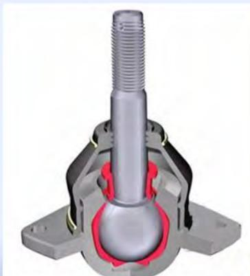
BALL JOINT ASSEMBLY - CONTROL ARM
